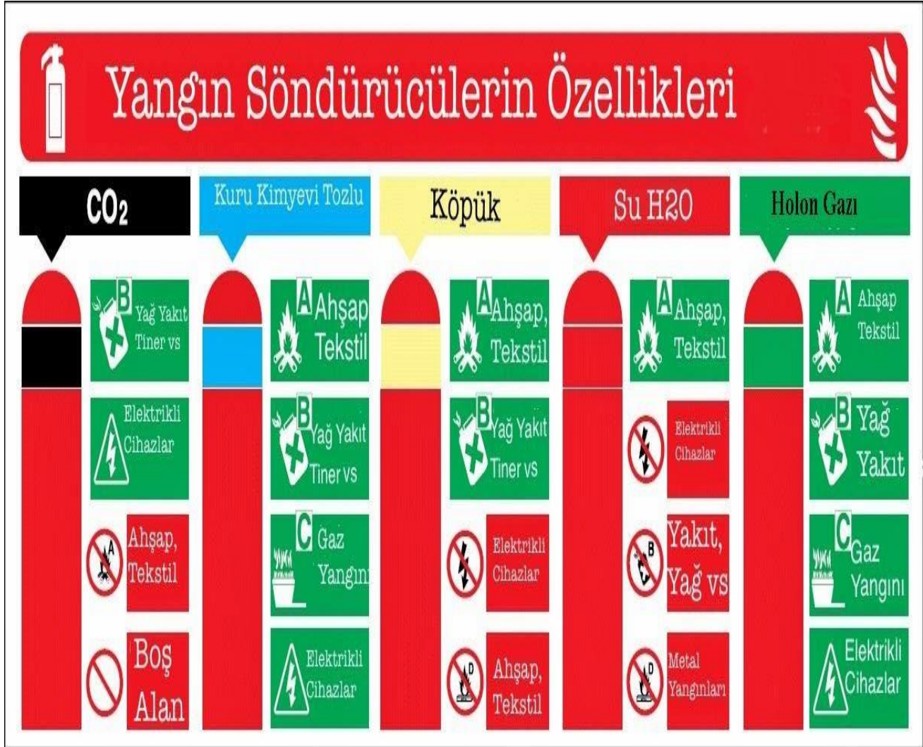
Şekil-1 Yangın Cinsine Göre Kullanılacak Söndürme Ekipmanları
